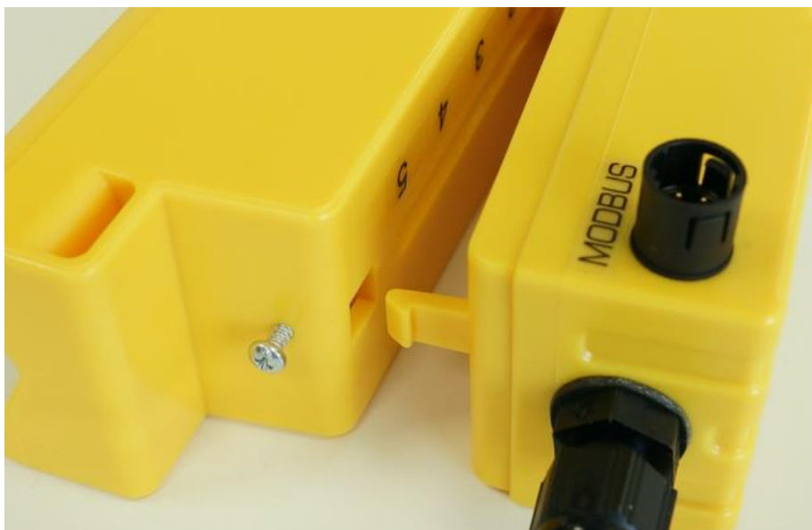
Figura 24 Separazione del gruppo sensori e del modulo elettronico
