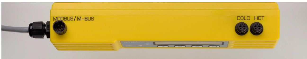
Figura 22 Connettori dei sensori di temperatura sul modulo elettronico
