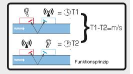
Wird der Ultraschall zwischen den Messwertgebern übertragen, wird er durch die Geschwindigkeit des hindurch strömenden Mediums in Strömungsrichtung etwas beschleunigt und gegen die Strömungsrichtung etwas abgebremst. Die daraus resultierende Zeitdifferenz ist direkt proportional zur Fließgeschwindigkeit des Mediums in der Leitung. Durch Messen der Fließgeschwindigkeit und Kenntnis des Querschnitts der Leitung ist eine einfache Berechnung des Volumenstroms möglich.
