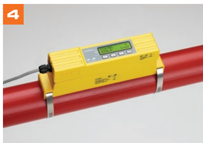
4 Far scattare il gruppo dell'elettronica sul binario e sul gruppo sensori
