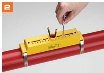
Fije el conjunto de riel guía y sensores a la tubería y afloje los tornillos de bloqueo de los sensores
