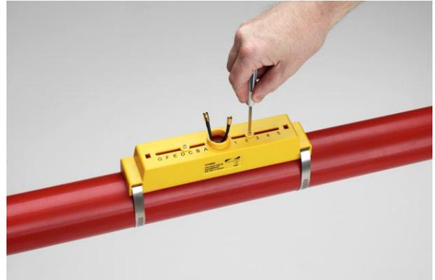
Prüfen Sie die Abstandstabelle auf Seite 8 oder programmieren Sie die Einheit, bevor Sie die Führungsschiene mit den mitgelieferten Bändern am Rohr befestigen. Lösen Sie Sie dann die Arretierschrauben des Sensors und **ENTFERNEN** Sie sie.
