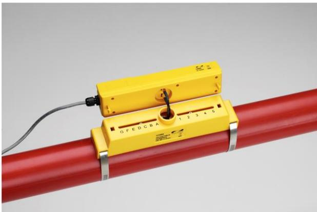
Verbinden Sie die Sensoren mit der Elektronikbaugruppe, bevor Sie sie mit Strom versorgen. Die Sensorleitungen können in beliebiger Richtung angeschlossen werden.
