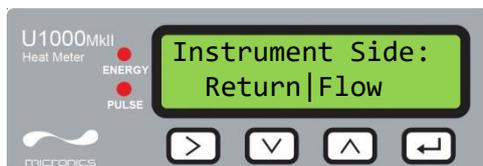
Seleccione en qué lado está instalada la unidad de componentes electrónicos mediante:
