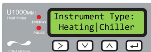
Seleccione el ajuste del instrumento mediante
