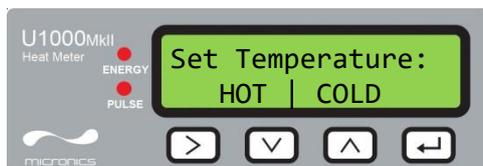
Si la temperatura del líquido está en el intervalo de 2 °C a 40 °C, seleccione "COLD" (frío). Si la temperatura del líquido está en el intervalo de 40 °C a 85 °C, seleccione "HOT" (caliente).
