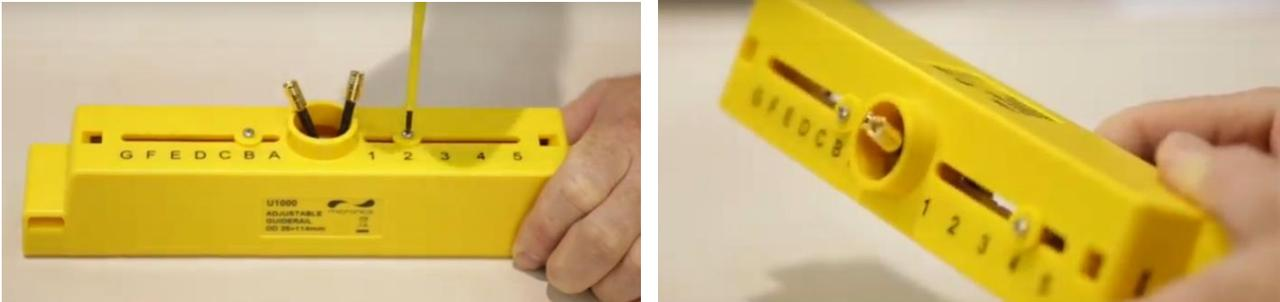
**Figura 14 Afloje los tornillos de fijación de los sensores de caudal (izquierda); deslice hasta la posición correcta (derecha)**
