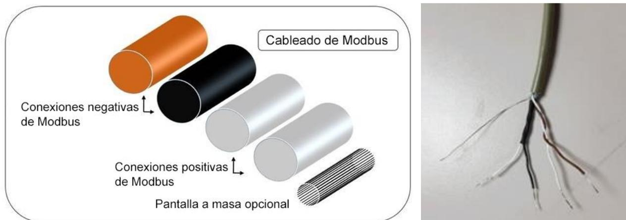
**Figura 8 Cableado Modbus**
