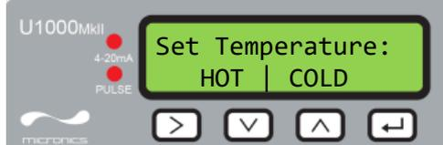
Si la temperatura del líquido está en el intervalo de 2 °C a 40 °C, seleccione "COLD" (frío). Si la temperatura del líquido está en el intervalo de 40 °C a 85 °C, seleccione "HOT" (caliente).
