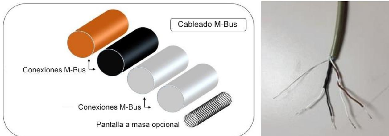
**Figura 11 Cableado M-Bus**
