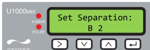
A continuación, la unidad muestra la separación correcta entre los sensores de caudal (en este caso, "B2"), de acuerdo con los valores seleccionados para el diámetro interno de la tubería, el material de la tubería y el líquido.
