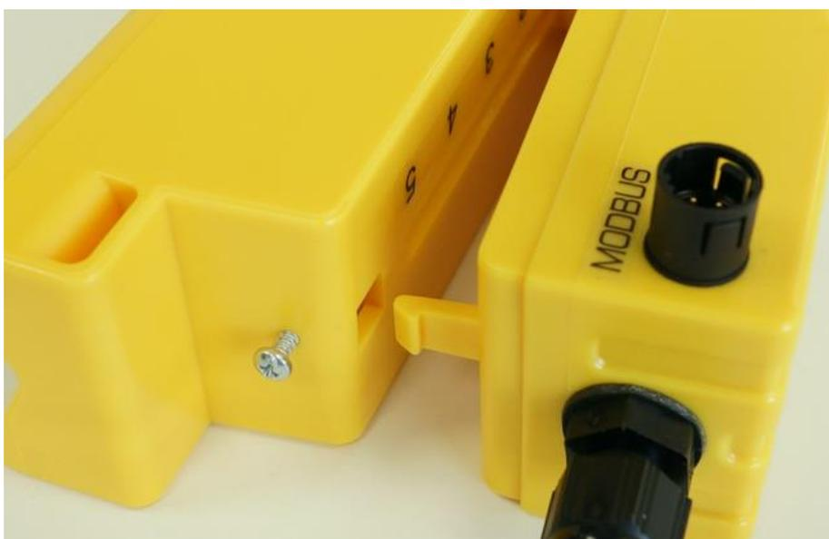
**Figura 24 Separación del conjunto de sensores y el módulo de componentes electrónicos**
