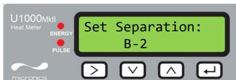
A continuación, la unidad muestra la separación correcta entre los sensores de caudal (en este caso, "B-2"), de acuerdo con los valores seleccionados para el diámetro interno de la tubería, el material de la tubería y el líquido.
