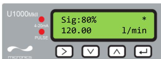
Wird ein gültiges Signal erkannt, werden die Signalstärke und die Flussrate angezeigt. Um einen zuverlässigen Betrieb sicherzustellen, sollte die Signalstärke bei einem Wert von mindestens 40 % liegen.
