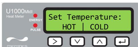
Wählen Sie „COLD“ (KALT) aus, wenn die Temperatur der Flüssigkeit in einem Bereich zwischen 2°C und 40°C liegt. Wählen Sie „HOT“ (HEIß) aus, wenn die Temperatur der Flüssigkeit in einem Bereich zwischen 40°C und 85°C liegt.
