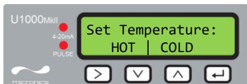
Wählen Sie „COLD“ (KALT) aus, wenn die Temperatur der Flüssigkeit in einem Bereich zwischen 2°C und 40°C liegt. Wählen Sie „HOT“ (HEIß) aus, wenn die Temperatur der Flüssigkeit in einem Bereich zwischen 40°C und 85°C liegt.
