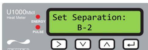
Das Gerät zeigt nun die korrekte Trennung des Durchflusssensors (in diesem Fall „B-2“) für die ausgewählten Werte des Rohr-Innendurchmessers und -materials sowie der Flüssigkeit an.
