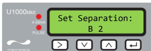
Das Gerät zeigt nun die korrekte Trennung des Durchflusssensors (in diesem Fall „B2“) für die ausgewählten Werte des Rohr-Innendurchmessers und -materials sowie der Flüssigkeit an.
