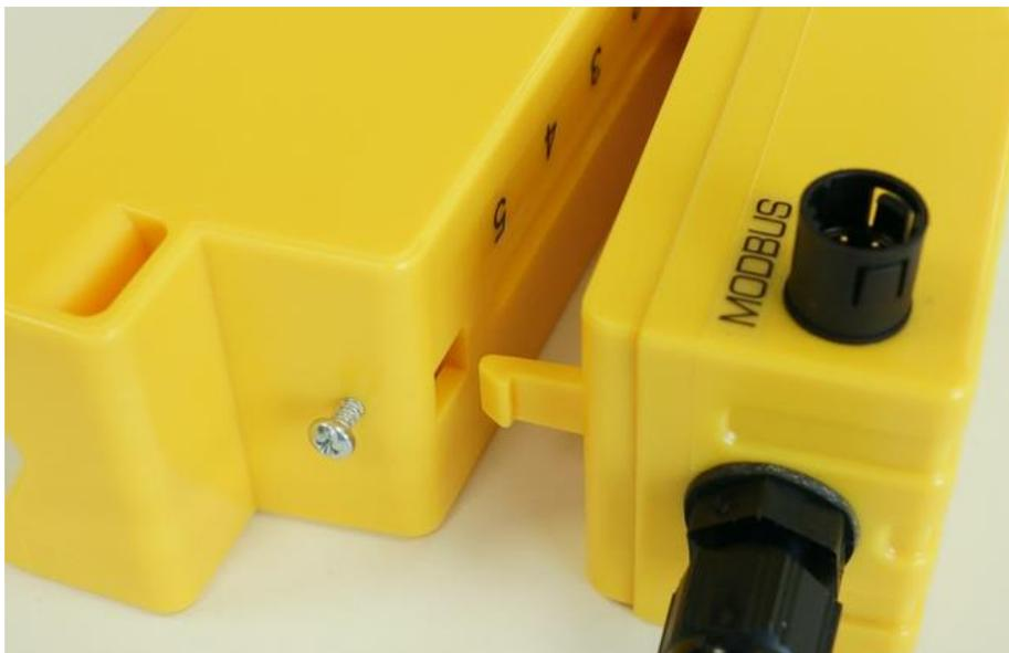
**Abbildung 24 Trennung des Sensorblocks und des Elektronikmoduls**
