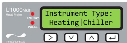
Wählen Sie mit
