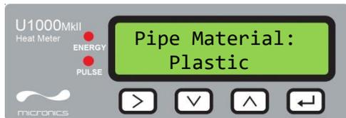
Wählen Sie das Rohrmaterial aus, indem Sie mit den Tasten
