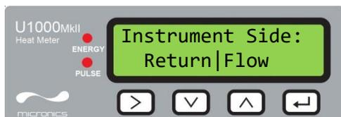
Wählen Sie mit
