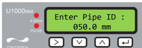
Anschließend werden Sie aufgefordert, den Innendurchmesser des Rohrs einzugeben:
