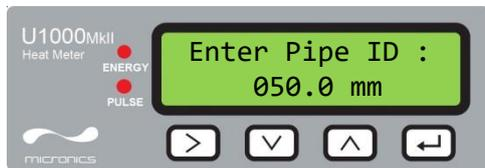
Anschließend werden Sie aufgefordert, den Innendurchmesser des Rohrs einzugeben:
