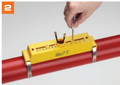
2 Fixer le rail de guidage et les capteurs sur le tuyau et libérer les vis de verrouillage des capteurs
