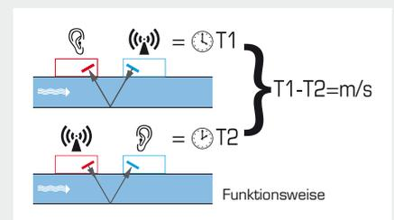
Wenn der Ultraschall zwischen den Wandlern übertragen wird, wird seine Geschwindigkeit leicht erhöht, wenn er sich in Flussrichtung bewegt, und leicht verringert, wenn er sich gegen die Flussrichtung bewegt. Die sich daraus ergebende Differenz der Übertragungszeit ist direkt proportional zur Durchflussgeschwindigkeit im Rohr. Nach der Messung der Durchflussgeschwindigkeit und mit Kenntnis des Rohrdurchschnitts, kann der Volumenfluss einfach berechnet werden.
