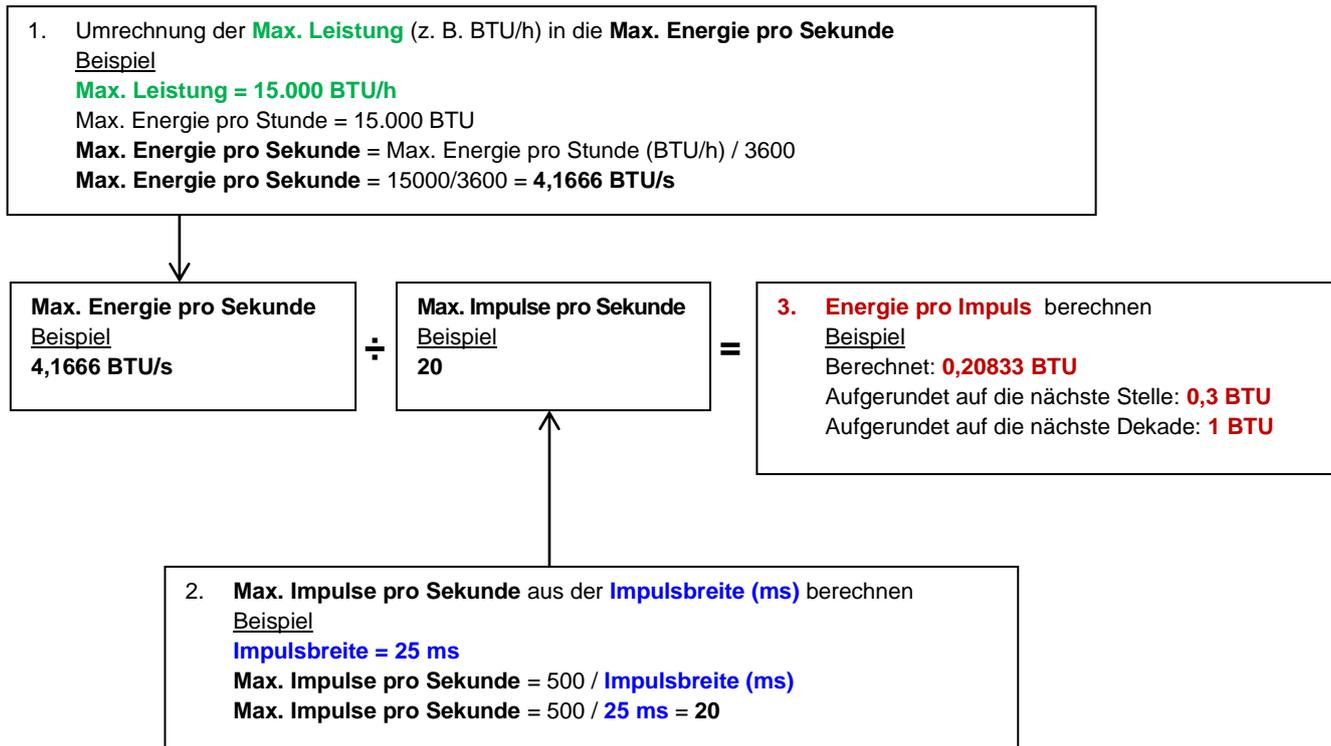
So berechnen Sie einen geeigneten Wert für die **Energie pro Impuls** aus der **Maximalen Leistung** und der **Impulsbreite** (metrische Einheiten)
