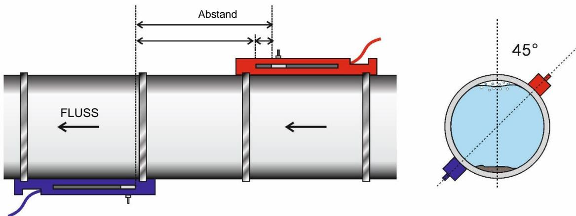
**Abbildung 18 Positionierung der Führungsschiene für den Diagonalmodus****Erforderlicher Messwandler-Abstand von mehr als 230 mm:**
