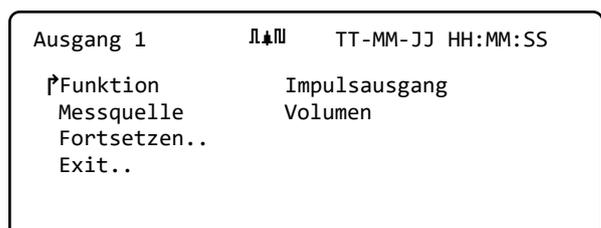
4. Verwenden Sie die Pfeiltasten AUF/AB, um durch die Ausgangstypen zu scrollen:
