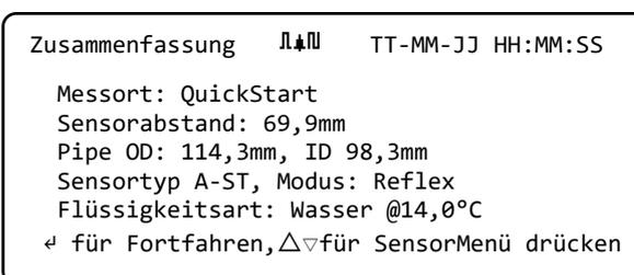
**HINWEIS: DRÜCKEN SIE ERST DIE ENTER-TASTE, WENN DIE KORREKTEN MESSWANDLER MONTIERT UND MIT DEM GERÄT VERBUNDEN SIND. WENN DIE DATEN EINEN FEHLER ENTHALTEN, DRÜCKEN SIE DIE TASTE „LÖSCHEN“, UM ZUM HAUPTMENÜ ZURÜCKZUKEHREN UND DIE VORHERIGEN EINSTELLUNGEN WIEDERHERZUSTELLEN.**
