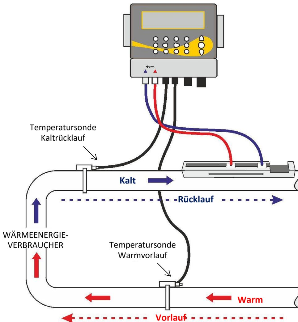
**Abbildung 19 Positionierung der Temperatursonde von Wärmezähler UF3300 (Heizsystem)**
