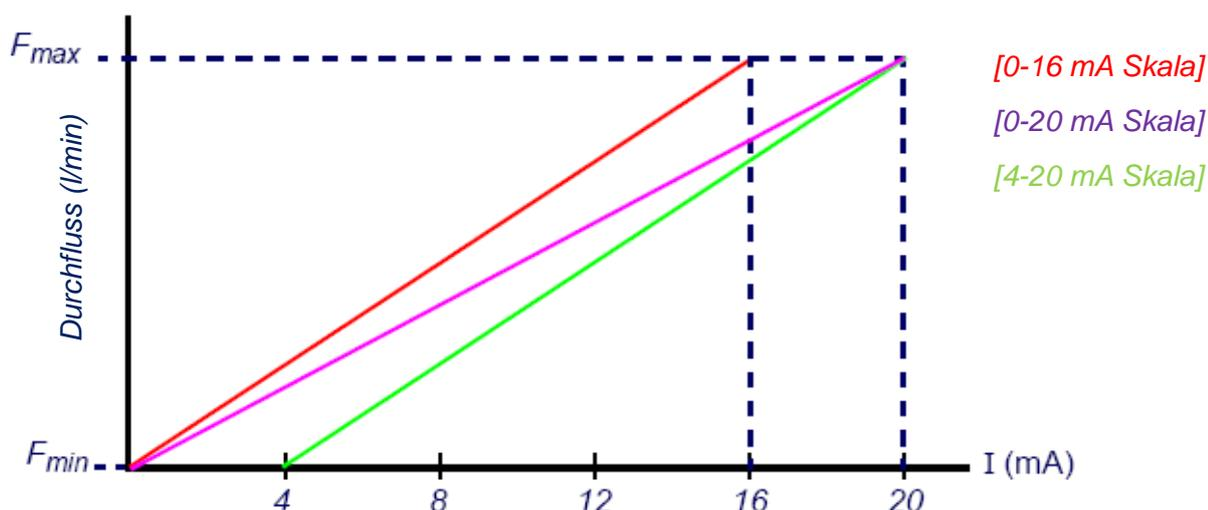
Für die Berechnung der Strömungsstärke (l/min) für einen gemessenen Strom (mA) gilt dann:
