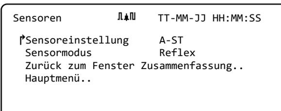
**HINWEIS: DER BILDSCHIRM SENSOREN WIRD AUTOMATISCH ANGEZEIGT, WENN DER EINGEGEBENE ROHRAUßENDURCHMESSER UND/ODER DIE TEMPERATUR FÜR DIE DERZEIT AUSGEWÄHLTEN SENSOREN NICHT GÜLTIG IST.**
