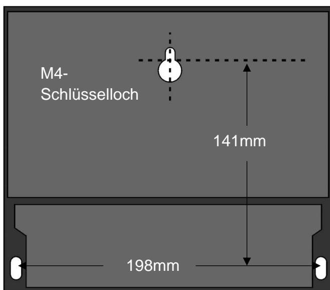
**Abbildung 7 UF3300-Montageabmessungen**
