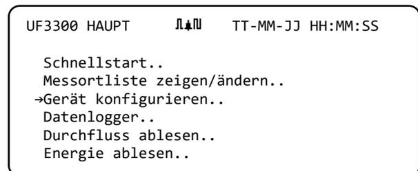
Alternativ können Sie in einem der Bildschirme *Durchfluss/Geschwindigkeit/Energie ablesen* die Taste SYSTEM (2) drücken. Das Menü *Systemeinstellungen* wird angezeigt.
