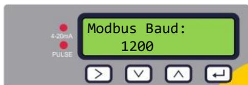
Inserire la frequenza baud per la rete Modbus. Le impostazioni valide sono 1200, 2400, 4800, 9600, 19200 o 38400.
