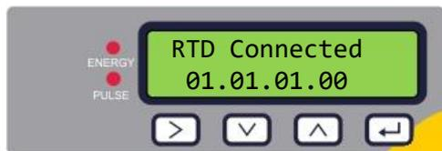
La versione del firmware installato sulla scheda RTD è mostrata sulla riga inferiore. La riga superiore mostra lo stato.
