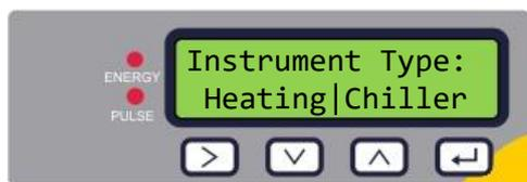
Selezionare il tipo di strumento utilizzando
