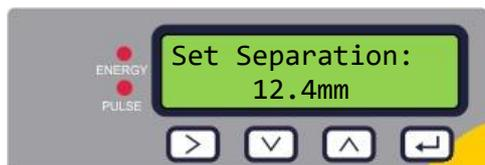
L'unità ora mostra la separazione corretta del sensore di flusso (in questo caso "12,4 mm") per i valori scelti di diametro del tubo, materiale del tubo e fluido.
