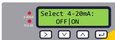
Abilitare o disabilitare l'uscita da 4-20mA utilizzando
