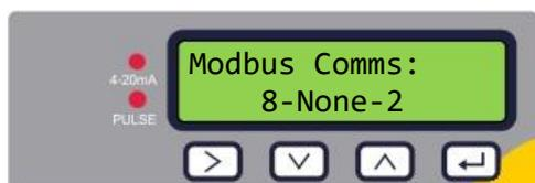
Selezionare il formato dei dati Modbus. Le impostazioni valide sono 8-None-2, 8-Even-1, 8-Odd-1, 8-None-1. Le impostazioni fanno riferimento al numero di bit di dati in ciascun carattere (8), alla parità (dispari, pari o nessuna) e al numero di bit di stop (1 o 2).
