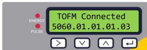
La versione del firmware installato sulla scheda del flusso è mostrata sulla riga inferiore. La riga superiore mostra lo stato.
