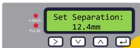
L'unità ora mostra la separazione corretta del sensore di flusso (in questo caso "12,4 mm") per i valori scelti del diametro del tubo, del materiale del tubo e del fluido.
