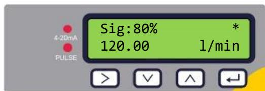
In presenza di un segnale valido, vengono visualizzate la potenza del segnale e la portata. Per garantire un funzionamento affidabile, la potenza del segnale dovrebbe essere almeno al 40%.
