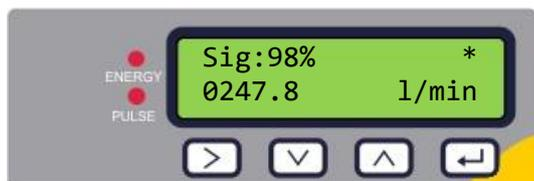
In presenza di un segnale valido, vengono visualizzate la potenza del segnale e la portata. Per garantire un funzionamento affidabile, la potenza del segnale dovrebbe essere almeno al 40%.
