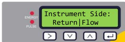
Selezionare il lato dello strumento (dove sono installati i sensori) utilizzando
