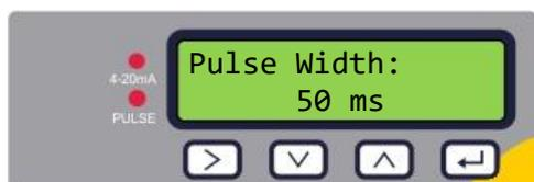
Impostare l'ampiezza dell'impulso. Il valore predefinito è 50 ms, che rappresenta la metà di un ciclo di impulso. Un'ampiezza dell'impulso di 50 ms è necessaria per la maggior parte dei contatori meccanici.
