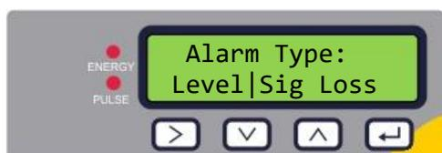
Scegliere il tipo di allarme: **Livello**, che si attiva in corrispondenza della più bassa portata accettabile, o **Perdita di segnale**, che indica una perdita o un malfunzionamento del flusso o del segnale.
