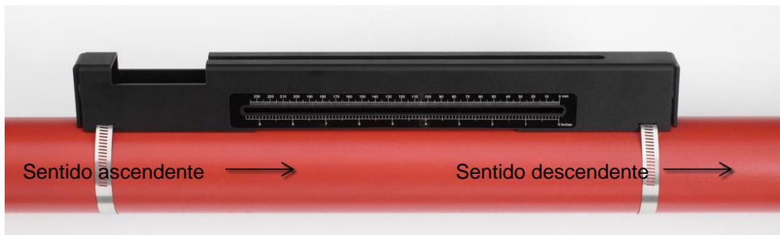
Figura 11 Instalación del riel guía
