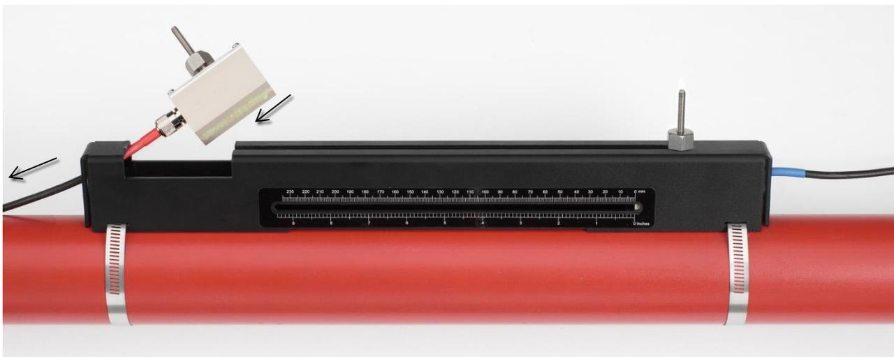
**Figura 15 Instalación del transductor de señal ascendente (rojo)**
