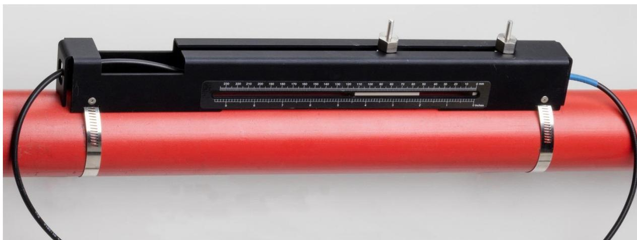
**Figure 17 Abaisser les transducteurs sur la canalisation**
